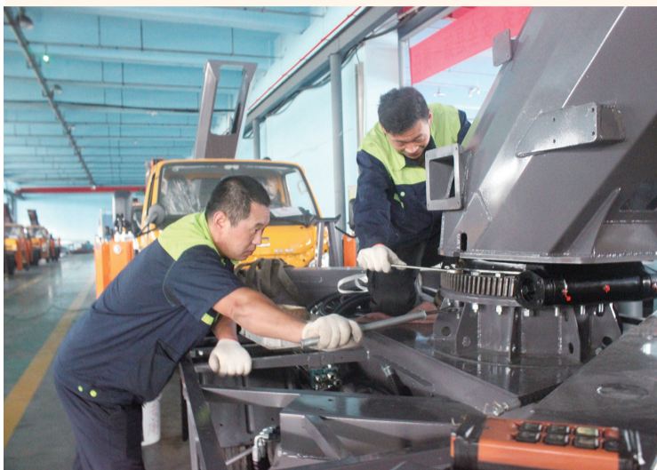
工人正在组装云梯车。
